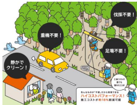
足場いらずの鉄筋挿入工「スタンドドライブ工法」
